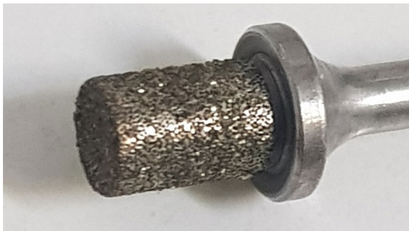
Ryc. 9. Końcówka pracująca wiertła dł. 6.0 mm – na szczycie wiertła widoczna wklęsła powieszchnia.
